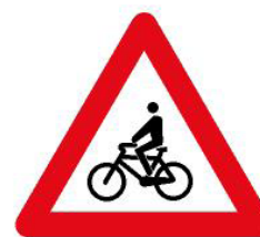
Fig 3: Cartello di pericolo per attraversamento ciclabile in strade extraurbane o urbane con velocità superiore a quello stabilito dall'art 142 comma 1 del CdS. (fig II 14 art 88, DPR 495/92)
