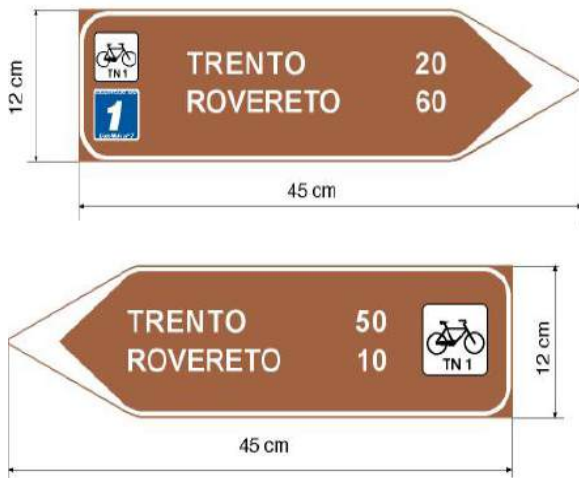
Fig 1: Segnale di direzione ottenuto dai segnali turistici per contesti extraurbani (riduzione da segnale tabella II 14a DPR 495/92)
