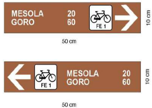
Fig 2: Segnale di direzione ottenuto dai segnali turistici per contesti urbani (riduzione da segnale tabella II 13a DPR 495/92)
