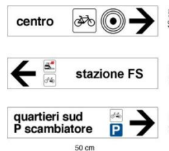
Fig 2: Segnali di direzione urbano (sottodimensionati per viabilità riservata) composto da fig. tab II 13/a e figure art. 125 DPR 495/92)
