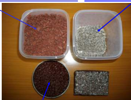
Carota di conglomerato additivato con ossido di ferro
